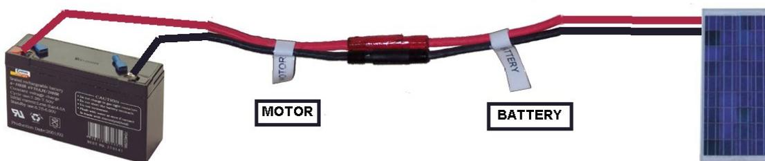
**En l'absence des joule mètres les connecteurs d'extrémités sont réunis entre eux pour assurer la liaison entre batterie et moteur et batterie et panneaux solaires**
